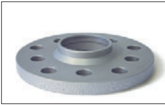
Artikel-Nr./Part-no. 24255570B: Radnabenlänge max. 14,5 mm. Felgeninnenfase mind. 5x45° Wheel hub length max. 14,5 mm. Inner bavel 5x45°
