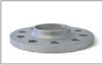
Artikel-Nr./Part-no. 2055668: Radnabenlänge max. 13,5 mm. Felgeninnenfase mind. 5x45° Wheel hub length max. 13,5 mm. Inner bavel 5x45°
