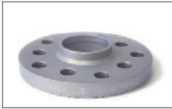
Artikel-Nr./Part-no. 30255570: Radnabenlänge max. 17 mm. Felgeninnenfase mind. 4x45° Wheel hub length max. 17 mm. Inner bavel 4x45°
