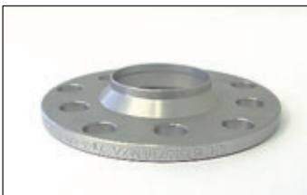
Artikel-Nr./Part-no. 162555716: Radnabenslänge max. 14 mm. Felgeninnenfase mind. 7x45° Wheel hub length max. 14 mm. Inner bavel 7x45°.
