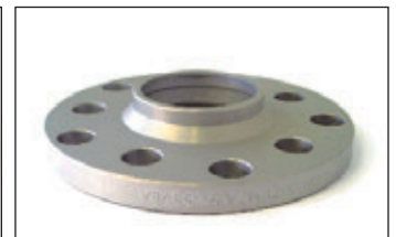
Artikel-Nr./Part-no. 24255571: Radnabenslänge max. 15 mm. Felgeninnenfase mind. 5x45° Wheel hub length max. 15 mm. Inner bavel 5x45°.
