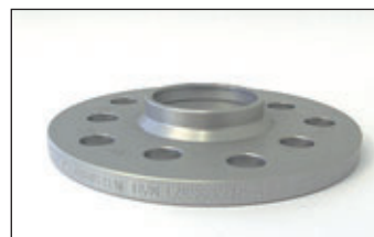
Artikel-Nr./Part-no. 2055571B: Radnabenslänge max. 12 mm. Felgeninnenfase mind. 4x45° Wheel hub length max. 12 mm. Inner bavel 4x45°.
