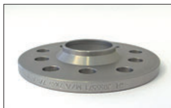
Artikel-Nr./Part-no. 2055571A: Radnabenslänge max. 15,5 mm. Felgeninnenfase mind. 6,5x45° Wheel hub length max. 15,5 mm. Inner bavel 6,5x45°.
