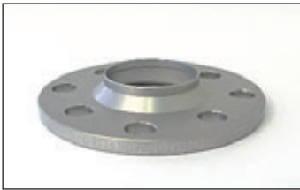
Artikel-Nr./Part-no. 162345712: Radnabenslänge max. 14 mm. Felgeninnenfase mind. 7x45° Wheel hub length max. 14 mm. Inner bavel 7x45°.
