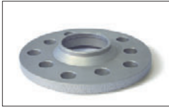
Artikel-Nr./Part-no. 20255570A: Radnabenlänge max. 15 mm. Felgeninnenfase mind. 7x45° Wheel hub length max. 15 mm. Inner bavel 7x45°
