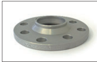
Artikel-Nr./Part-no. 202345714: Radnabenslänge max. 16 mm. Felgeninnenfase mind. 7x45° Wheel hub length max. 16 mm. Inner bavel 7x45°.
